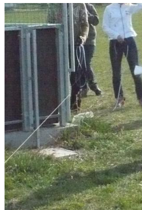
Obrázok 2: Meranie vzdialenosti medzi dvoma stanovišťami cez prekážku
